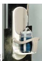
砂袋の繰り返し落下試験 ※写真は Combi ベビーキープ・スリムW62
